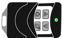
5º- O duplicador indicará que o código foi gravado através de piscadas no led. Inicialmente o led piscará em vermelho para confirmar a cópia da frequência, após o led ficará piscando em verde até capturar código. Quando a cópia estiver finalizada o led piscará intermitentemente na cor verde e vermelha.
